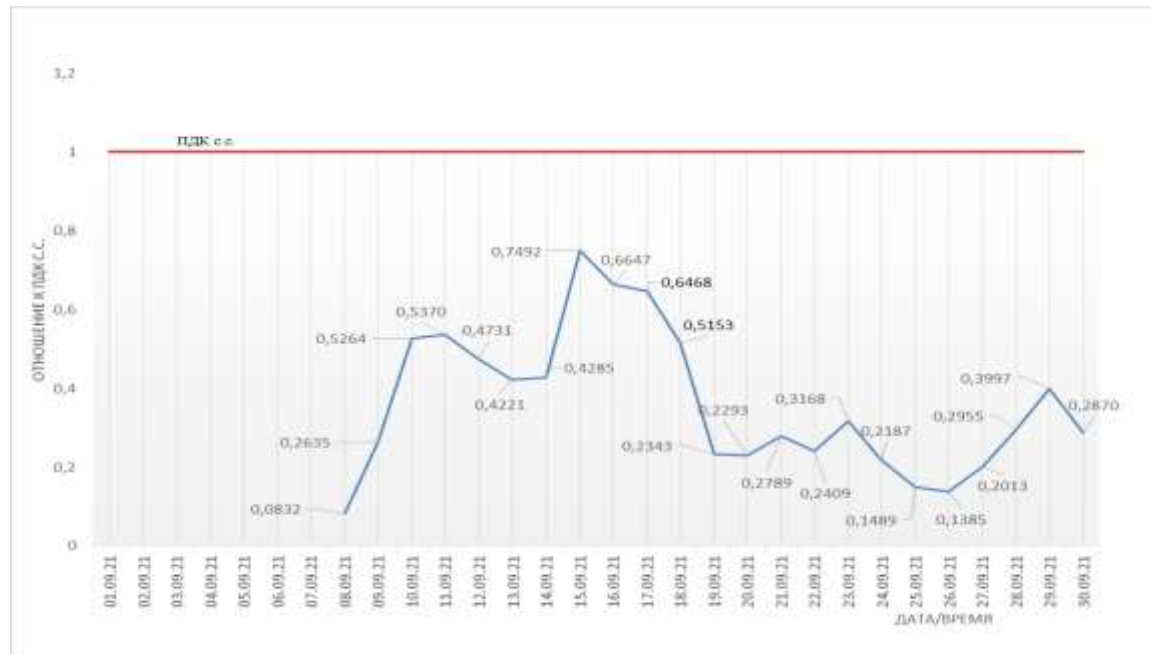
График среднесуточных значений концентраций взвешенных веществ ( \text{мг}/\text{м}^3 ) в атмосферном воздухе в период 01.09.2021г. по 30.09.2021г. (ПКЗ 4 - автоматическая станция ул. Проспект Чекистов)
