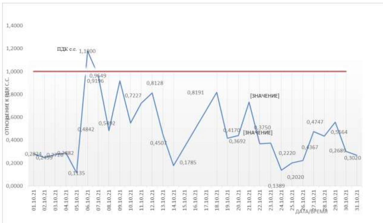
График среднесуточных значений концентраций загрязняющих веществ (мг/м 3 ) в атмосферном воздухе в период 01.10.2021г. по 31.10.2021г. (ПКЗ 4 - автоматическая станция ул. Проспект Чекистов)
